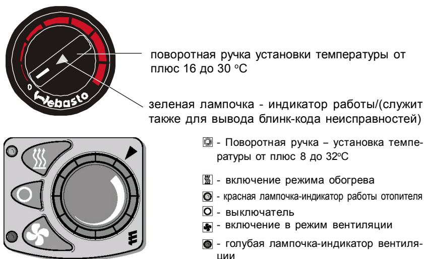
Рисунок 3.28 – Органы управления независимым воздушным отопителем
